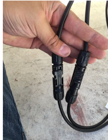
Muestra de las conexiones hembra y macho entre celda y microinversor
